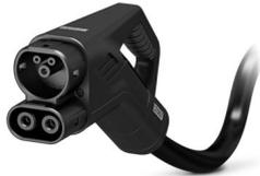
CHARX connect standard, CCS Typ 2, DC-Ladeleitung, 200 A dauerhaft, 1000 V DC, mit Fahrzeug-Ladestecker und offenem Leitungsende, Kabel: 7 m, schwarz, gerade, unterstützt Vier-Leiter-Messtechnik, mit analoger Temperatursensorik, mit austauschbarem Steckgesichtrahmen, mit austauschbaren DC-Leistungskontakten, mit angeschlossenem PP-Kontakt, PHOENIX CONTACT-Logo, IEC 62196-3, zum Laden mit Gleichstrom (DC) von Elektrofahrzeugen (EV)
