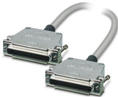
Konfektioniertes, geschirmtes, halogenfreies Rundkabel; Steuerung: SIEMENS ET 200SP HA (F-DQ10x24VDC/2A HA (6DL1136-6DA00-0PH1)); Anschluss 1: D-SUB-Buchsenleiste (1x 37-polig) (angeschlossene Pole: 20); Anschluss 2: D-SUB-Buchsenleiste (1x 37-polig) (angeschlossene Pole: 20); Kabellänge: 6 m
