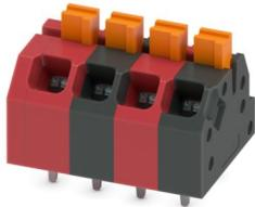
Leiterplattenklemme, Nennstrom: 16 A, Bemessungsspannung (III/2): 160 V, Nennquerschnitt: 1,5 mm<sup>2</sup>, Anzahl der Reihen: 1, Polzahl pro Reihe: 4, Artikelfamilie: SPTAF 1/..-EL, Rastermaß: 3,5 mm, Anschlussart: Push-in-Federanschluss, Montage: Wellenlöten, Anschlussrichtung Leiter/Platine: 45 °, Farbe: mehrfarbig, Pin-Layout: Lineares Pinning, Pinlänge [P]: 2,6 mm, Anzahl der Lötpins pro Potenzial: 2, Verpackungsart: verpackt im Karton
