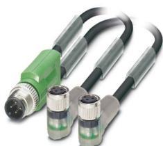
Sensor-/Aktor-Kabel, 3-polig, PUR halogenfrei, schwarzgrau RAL 7021, Stecker gerade M12, Kodierung: A, auf Buchse gewinkelt M8, Kodierung: A, mit 2 LEDs und Buchse gewinkelt M8, Kodierung: A, mit 2 LEDs, Kabellänge: 1,5 m
