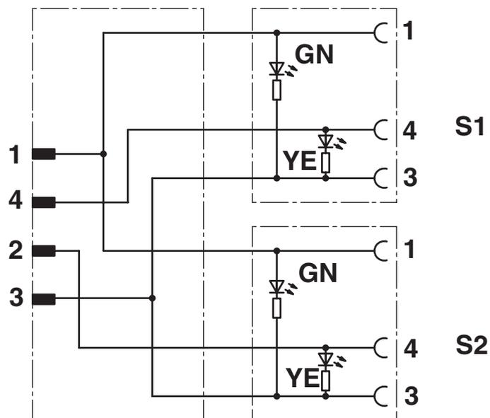
Kontaktbelegung der M12-Stecker / M8-Buchse
