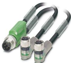
Sensor-/Aktor-Kabel, 3-polig, PUR halogenfrei, schwarzgrau RAL 7021, Stecker gerade M12, Kodierung: A, auf Buchse gewinkelt M8, Kodierung: A, mit 2 LEDs und Buchse gewinkelt M8, Kodierung: A, mit 2 LEDs, Kabellänge: 0,3 m
