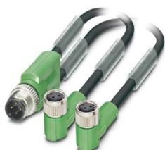
Sensor-/Aktor-Kabel, 3-polig, PUR halogenfrei, schwarzgrau RAL 7021, Stecker gerade M12, Kodierung: A, auf Buchse gewinkelt M8, Kodierung: A und Buchse gewinkelt M8, Kodierung: A, Kabellänge: 0,6 m
