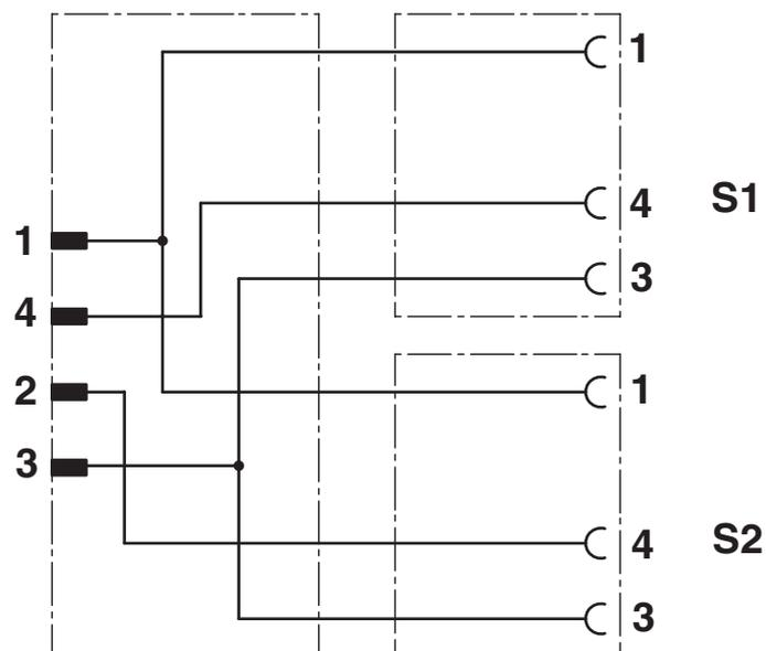
Kontaktbelegung der M12-Stecker / M8-Buchse
