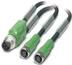
Sensor-/Aktor-Kabel, 3-polig, PUR halogenfrei, schwarzgrau RAL 7021, Stecker gerade M12, Kodierung: A, auf Buchse gerade M8, Kodierung: A und Buchse gerade M8, Kodierung: A, Kabellänge: 3 m
