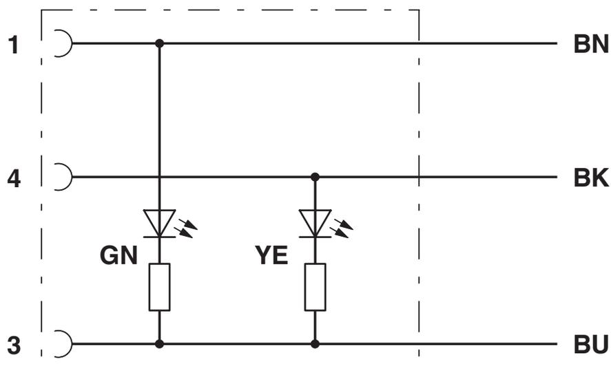
Kontaktbelegung der M8-Buchse mit 2 LED
