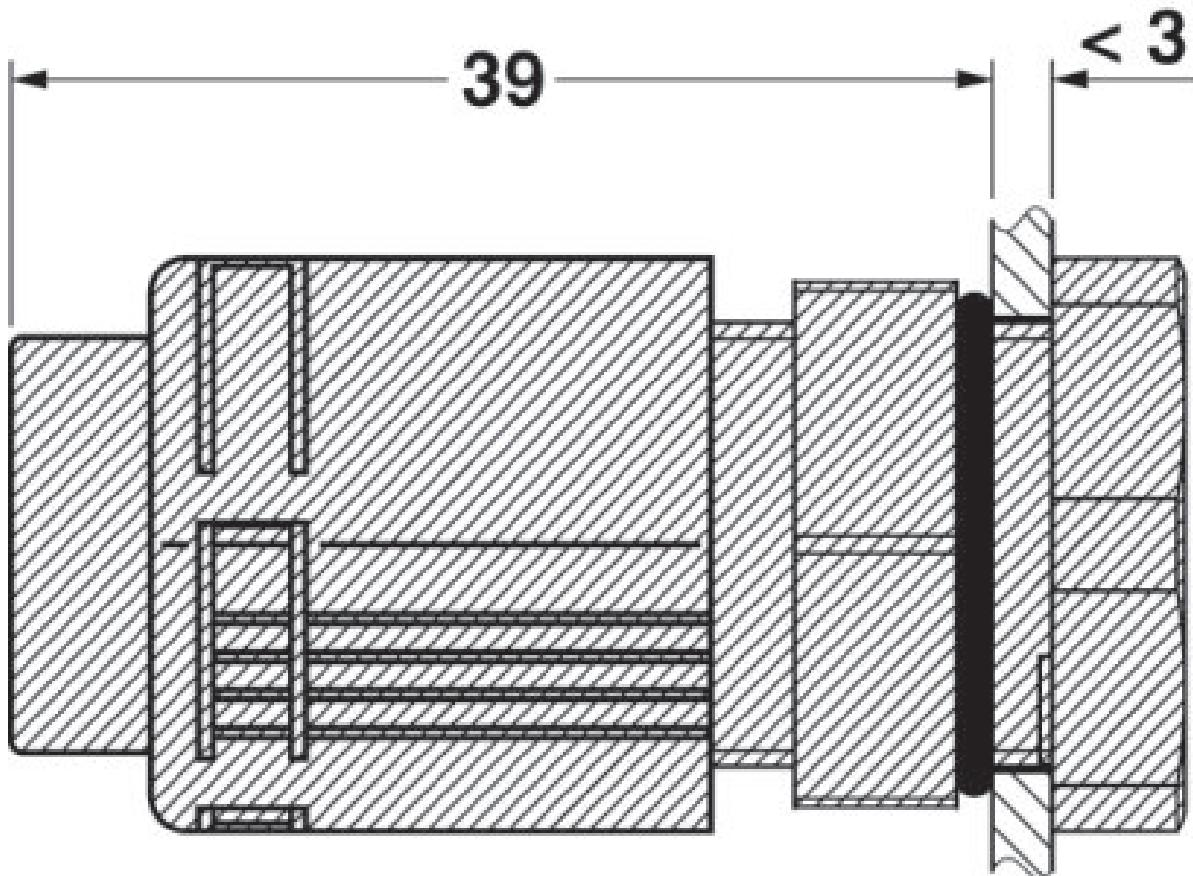
QUICKON-Wanddurchführung mit Sicherheitsmutter Q-SMU PG 13,5, gekontert mit der Gegenmutter Q-MU PG 13,5.
