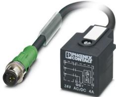
Sensor-/Aktor-Kabel, 3-polig, PUR halogenfrei, schwarzgrau RAL 7021, Stecker gerade M12, Kodierung: A, auf Ventilstecker A, mit 1 LED, Beschaltung: Z-Diode, Kabellänge: 1,5 m
