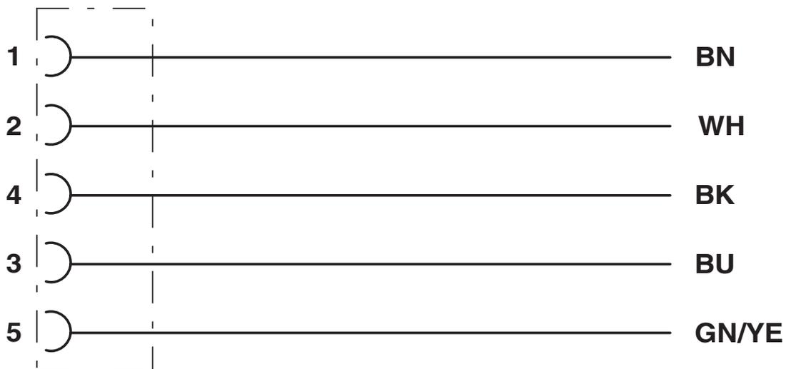
Kontaktbelegung der M12-Buchsen
