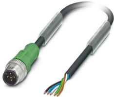
Sensor-/Aktor-Kabel, 5-polig, PUR halogenfrei, schwarzgrau RAL 7021, Stecker gerade M12, Kodierung: A, auf freies Leitungsende, Kabellänge: 3 m
