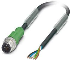
Sensor-/Aktor-Kabel, 5-polig, PUR halogenfrei, schwarzgrau RAL 7021, Stecker gerade M12, Kodierung: A, auf freies Leitungsende, Kabellänge: 1,5 m
