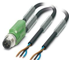
Sensor-/Aktor-Kabel, 3-polig, PUR halogenfrei, schwarzgrau RAL 7021, ungeschirmt, Stecker gerade M12, Kodierung: A, auf freies Leitungsende und freies Leitungsende, Kabellänge: 1,5 m
