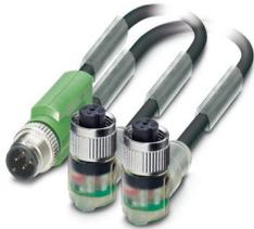
Sensor-/Aktor-Kabel, 3-polig, PUR halogenfrei, schwarzgrau RAL 7021, Stecker gerade M12, Kodierung: A, auf Buchse gewinkelt M12, Kodierung: A, mit 2 LEDs, PIN 2+4 gebrückt und Buchse gewinkelt M12, Kodierung: A, mit 2 LEDs, PIN 2+4 gebrückt, Kabellänge: 0,6 m
