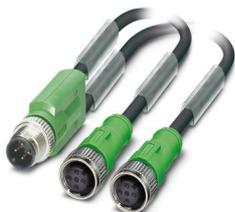
Sensor-/Aktor-Kabel, 3-polig, PUR halogenfrei, schwarzgrau RAL 7021, Stecker gerade M12, Kodierung: A, auf Buchse gerade M12, Kodierung: A, PIN 2+4 gebrückt und Buchse gerade M12, Kodierung: A, PIN 2+4 gebrückt, Kabellänge: 3 m
