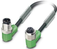
Sensor-/Aktor-Kabel, 4-polig, PUR halogenfrei, schwarzgrau RAL 7021, Stecker gewinkelt M12, Kodierung: A, auf Buchse gewinkelt M12, Kodierung: A, Kabellänge: 1,5 m
