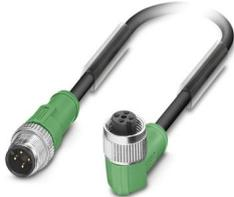
Sensor-/Aktor-Kabel, 4-polig, PUR halogenfrei, schwarzgrau RAL 7021, Stecker gerade M12, Kodierung: A, auf Buchse gewinkelt M12, Kodierung: A, Kabellänge: 0,3 m
