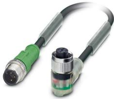
Sensor-/Aktor-Kabel, 3-polig, PUR halogenfrei, schwarzgrau RAL 7021, Stecker gerade M12, Kodierung: A, auf Buchse gewinkelt M12, Kodierung: A, mit 2 LEDs, PIN 2+4 gebrückt, Kabellänge: 0,3 m
