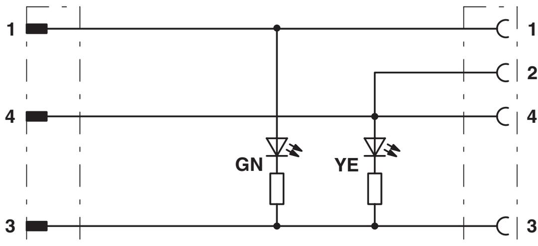
Kontaktbelegung der M12-Stecker / Buchsen gebrückt mit LED
