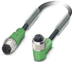
Sensor-/Aktor-Kabel, 3-polig, PUR halogenfrei, schwarzgrau RAL 7021, Stecker gerade M12, Kodierung: A, auf Buchse gewinkelt M12, Kodierung: A, PIN 2+4 gebrückt, Kabellänge: 0,6 m
