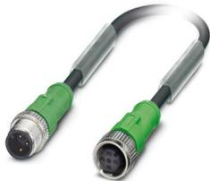
Sensor-/Aktor-Kabel, 3-polig, PUR halogenfrei, schwarzgrau RAL 7021, Stecker gerade M12, Kodierung: A, auf Buchse gerade M12, Kodierung: A, PIN 2+4 gebrückt, Kabellänge: 1,5 m
