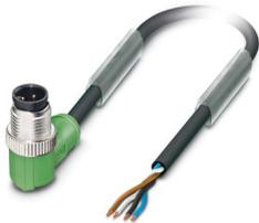
Sensor-/Aktor-Kabel, 4-polig, PUR halogenfrei, schwarzgrau RAL 7021, Stecker gewinkelt M12, Kodierung: A, auf freies Leitungsende, Kabellänge: 5 m
