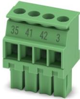
Leiterplattenstecker, Nennquerschnitt: 1,5 mm<sup>2</sup>, Farbe: grün, Nennstrom: 8 A, Bemessungsspannung (III/2): 160 V, Kontaktoberfläche: Sn, Kontaktart: Buchse, Anzahl der Reihen: 1, Polzahl: 4, Artikelfamilie: MCVW 1,5/..-ST, Rastermaß: 3,5 mm, Anschlussart: Schraubanschluss mit Zughülse, Schraubenangriffsform: L Längsschlitz, Anschlussrichtung Leiter/Platine: -90 °, Stecksystem: COMBICON MC 1,5, Verriegelung: ohne, Befestigungsart: ohne, Verpackungsart: verpackt im Karton
