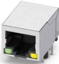
RJ45-Leiterplatten-Steckverbinder, Polzahl: 8, 2 x LED (grün, gelb), 1 GBit/s, THR-Lötanschluss, Schutzart: IP20, Tape and Reel
