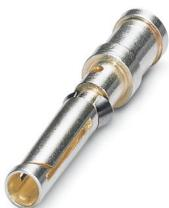
Crimpkontakt, Serie: HC-M-12, Buchse, gedreht, Kontaktdurchmesser: 1,6 mm, Anschlussquerschnitt: 0,5 mm<sup>2</sup> ... 0,5 mm<sup>2</sup>, AWG 20...20, Material Kontakt: Cu-Legierung
