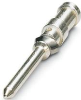
Crimpkontakt, Serie: HC-M-12, Stift, gedreht, Kontaktdurchmesser: 1,6 mm, Anschlussquerschnitt: 2,5 mm<sup>2</sup> ... 2,5 mm<sup>2</sup>, AWG 14...14, Material Kontakt: Cu-Legierung
