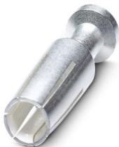
Crimpkontakt, Serie: HC-M-03, Buchse, gedreht, Kontaktdurchmesser: 4 mm, Anschlussquerschnitt: 6 mm<sup>2</sup> ... 6 mm<sup>2</sup>, AWG 10...10, Material Kontakt: Cu-Legierung
