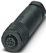
Steckverbinder, Universal, 5-polig, Buchse gerade M12, Kodierung: A, Schraubanschluss, Rändelmaterial: Kunststoff, Kabelverschraubung Pg7, Leitungsaußendurchmesser 4 mm ... 6 mm
