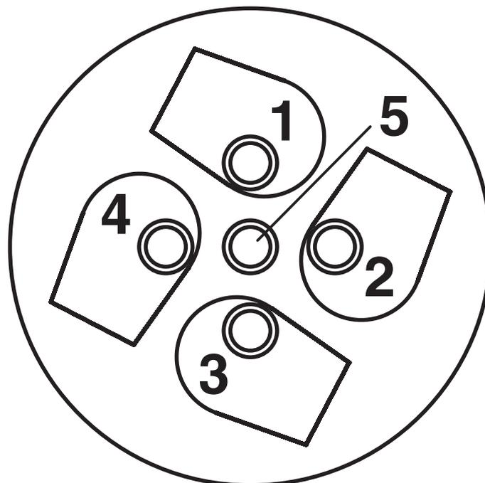
Kabelanschlusseite M12 (Schraubanschluss)
