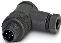
Steckverbinder, Universal, 5-polig, Stecker gewinkelt M12, Kodierung: A, Schraubanschluss, Rändelmaterial: Kunststoff, Kabelverschraubung Pg7, Leitungsaußendurchmesser 4 mm ... 6 mm
