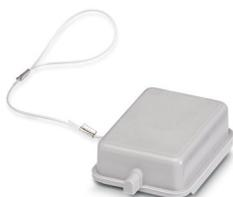
Schutzdeckel B6, für Längsbügel, Material Schutzdeckel: PA, Höhe: 18,5 mm, Dichtung: nein, mit Fangschnur
