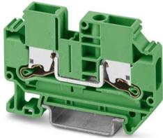
Durchgangsklemme, Nennspannung: 1000 V, Nennstrom: 41 A, Anzahl der Anschlüsse: 2, Polzahl: 1, Anschlussart: Push-X-Anschluss, Bemessungsquerschnitt: 6 mm<sup>2</sup>, Querschnitt: 0,5 mm<sup>2</sup> - 10 mm<sup>2</sup>, Montageart: NS 35/7,5, NS 35/15, Farbe: grün
