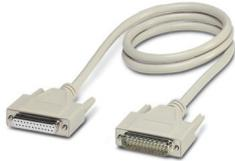
Konfektioniertes D-SUB-Kabel geschirmt, 25-polig, flexibel (7-drähtig), Kabelfarbe RAL 7000 (grau), Schutzart IP20, Kopf 1 mit Buchse Shell 3 und geraden Kabelabgang, Kopf 2 mit Stift Shell 3 und geraden Kabelabgang, Länge: 2 m
