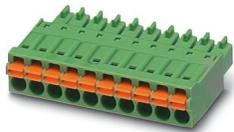
Leiterplattenstecker, Nennquerschnitt: 1,5 mm<sup>2</sup>, Farbe: grün, Nennstrom: 8 A, Bemessungsspannung (III/2): 160 V, Kontaktoberfläche: Sn, Kontaktart: Buchse, Anzahl der Reihen: 1, Polzahl: 9, Artikelfamilie: FMC 1,5/-ST, Rastermaß: 3,5 mm, Anschlussart: Push-in-Federanschluss, Anschlussrichtung Leiter/Platine: 0 °, Stecksystem: COMBICON FMC 1,5 - MCDN 1,5, Verriegelung: ohne, Befestigungsart: ohne, Verpackungsart: verpackt im Karton
