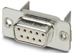
D-SUB-Kontakteinsatz, Shell-Größe 1, mit 9 Signalkontakten, Kontaktart Buchse, für Leiterplattenmontage, abgewinkelt, Befestigung mittels Bohrung 2,5 mm und Lötblech, für Anbaurahmen VS-09-...
