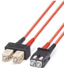
Konfektioniertes LWL-Kabel, Break-Out-Kabel, Glasfaser Multimode 50/125  $\mu\text{m}$ , SC-RJ/IP20 auf SC-Duplex/IP20, für die Verlegung innerhalb von Schaltschränken, Länge: 5 m
