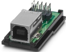
USB-Buchseneinsatz, 4-polig, Buchse USB Typ B auf Flachbandkabel-Anschlussleiste, Rastermaß 2,54, für das Freenet-System im Anbaurahmen, Terminaloutlet IP20, 19" Patch-Panel und Service-Interface
