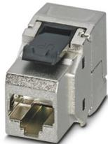
RJ45-Buchseinsatz, modular (Keystone), CAT6, 8-polig, geschirmt, mit Kabelanschluss (LSA), für Litze und starre Adern AWG 26 ... 22
