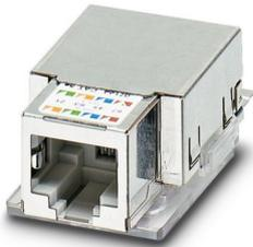
RJ45-Buchseneinsatz, Bauform: RJ45, Schutzart: IP20, Polzahl: 8, CAT5, Material: Metall, Anschlussart: IDC-Anschluss, Anschlussquerschnitt: AWG 24- 22, Ethernet
