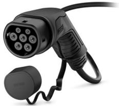
CHARX connect comfort, Typ 2, AC-Ladeleitung, 32 A dauerhaft, 250 V AC, mit Fahrzeug-Ladestecker und offenem Leitungsende, Kabel: 8 m, schwarz, gerade, mit Schutzkappe, PHOENIX CONTACT-Logo, IEC 62196-2, zum Laden mit Wechselstrom (AC) von Elektrofahrzeugen (EV) mit Typ 2 Fahrzeug-Ladedosen
