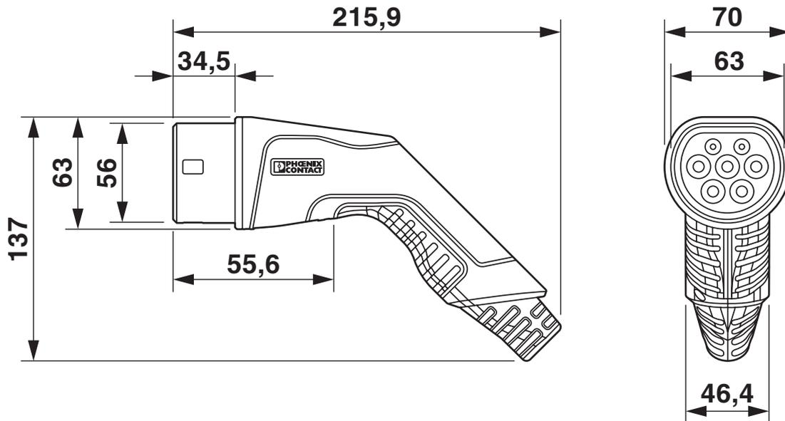
Stellen Sie sicher, dass der Fahrzeug-Ladestecker während der gesamten Ladepausenzeit in eine geeignete Ladesteckerhalterung gesteckt wird, die einen Schutz von mindestens IP24 nach IEC 61851-1 gewährleistet. Zur Erstellung einer solchen Ladesteckerhalterung verwenden Sie die Maße des Fahrzeug-Ladesteckers. Detailliertere Maßangaben finden Sie auch im Download-Bereich.
