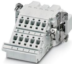
HEAVYCON Klemmenadapter, Stifteinsatz, Serie B10, 10-polig, für die linke Schaltschrankseite, Push-in-Anschluss
