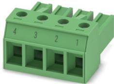
Leiterplattenstecker, Nennquerschnitt: 4 mm<sup>2</sup>, Farbe: grün, Nennstrom: 20 A, Bemessungsspannung (III/2): 630 V, Kontaktoberfläche: Sn, Kontaktart: Buchse, Anzahl der Reihen: 1, Polzahl: 4, Artikelfamilie: PC 4/..-ST, Rastermaß: 7,62 mm, Anschlussart: Schraubanschluss mit Zughülse, Schraubenangriffsform: L Längsschlitz, Anschlussrichtung Leiter/Platine: 0 °, Rasthaken: - Rasthaken, Stecksystem: COMBICON PC 4, Verriegelung: ohne, Befestigungsart: ohne, Verpackungsart: verpackt im Karton
