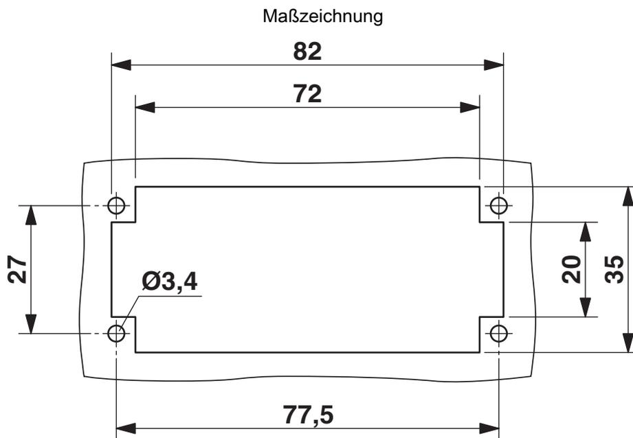
Montageausschnitt bei Verwendung ohne Gehäuse
