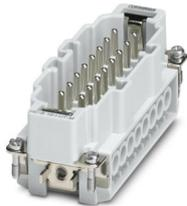
Kontakteinsatz, Polzahl: 16+PE, Baugröße: B16, Anzahl der Anschlüsse je Pol: 1, Stift, Schraubanschluss, 500 V, 16 A, 0,5 mm<sup>2</sup> ... 2,5 mm<sup>2</sup>, Anwendung: Leistung
