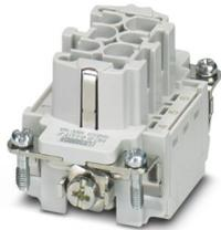
Kontakteinsatz, Polzahl: 6+PE, Baugröße: B6, Anzahl der Anschlüsse je Pol: 1, Buchse, Crimpanschluss, 500 V, 16 A, 0,5 mm<sup>2</sup> ... 4 mm<sup>2</sup>, Anwendung: Leistung
