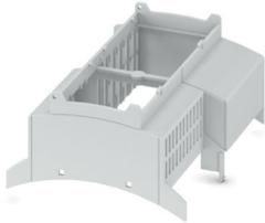
Tragschienengehäuse für den Einsatz in Installationsverteilern nach DIN 43880, modulares Gehäuseoberteil, Breite: 107,6 mm, Höhe: 89,7 mm, Tiefe: 54,85 mm, Farbe: lichtgrau (ähnlich RAL 7035)
