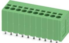
Leiterplattenklemme, Nennstrom: 17,5 A, Bemessungsspannung (III/2): 200 V, Nennquerschnitt: 1,5 mm<sup>2</sup>, Anzahl der Reihen: 1, Polzahl pro Reihe: 12, Artikelfamilie: SPT 1,5/..-V, Rastermaß: 3,5 mm, Anschlussart: Push-in-Federanschluss, Montage: Wellenlöten, Anschlussrichtung Leiter/Platine: 90 °, Farbe: grau, Pin-Layout: Lineares Pinning, Pinlänge [P]: 2,5 mm, Anzahl der Lötpins pro Potenzial: 2, Verpackungsart: verpackt im Karton
