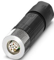
Power-Steckverbinder, Leistung, 5-polig, ungeschirmt, Buchse gerade M12, Kodierung: L, Push-Lock-Federanschluss, Rändelmaterial: Zinkdruckguss, vernickelt, Leitungsaußendurchmesser 8 mm ... 13 mm, Kontakt 5 voreilend
