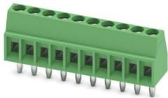
Leiterplattenklemme, Nennstrom: 6 A, Bemessungsspannung (III/2): 160 V, Nennquerschnitt: 0,5 mm<sup>2</sup>, Anzahl der Reihen: 1, Polzahl pro Reihe: 10, Artikelfamilie: MPT 0,5, Rastermaß: 2,54 mm, Anschlussart: Schraubanschluss mit Zughülse, Schraubenangriffsform: L Längsschlitz, Montage: Wellenlöten, Anschlussrichtung Leiter/Platine: 0 °, Farbe: grün, Pin-Layout: Lineares Pinning, Pinlänge [P]: 3,5 mm, Anzahl der Lötpins pro Potenzial: 1, Verpackungsart: verpackt im Karton
