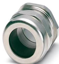
Metall-Verschraubung bis 5 bar, Gewindelänge: 8 mm, Kabeldurchmesser : 19 - 27 mm, SW 43, Verschraubung: M32
