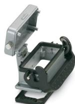
Anbaugehäuse B16, mit Längsbügel, Material: Aluminiumdruckguss, Material Schutzdeckel: Al, Höhe: 29 mm, Kabelverschraubung: ohne, Schutzdeckel: ja, Standard, mit Flachdichtung
